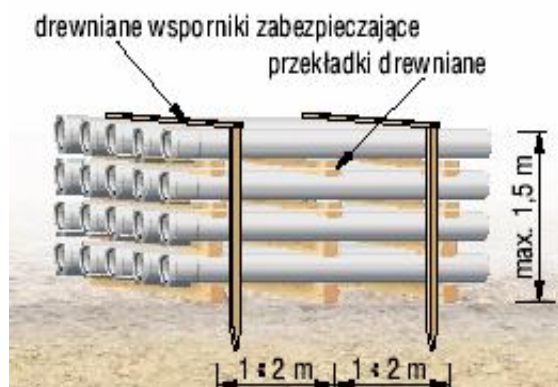
Rys. Składowanie rur na placu budowy
